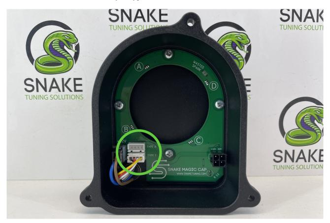
\* Connect white connector to «Type A» or «Type C»
